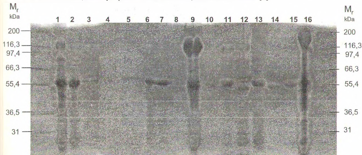
Рис.1. Электрофорез в SDS-ПААГ. 1 – 10 мМ EDTA pH 8.0; 2 – 10 мМ EGTA pH 8.0; 3 – 100мМ HEPES pH 2.0; 4 – 100мМ HEPES pH 3.0; 5 – 100 мМ HEPES pH 4.0; 6 – 200мМ глицин/HCl pH 2.0; 7 – 200 мМ глицин/HCl pH 4.0; 8 – 100 мМ трис/HCl pH 2.0; 9 – 1М мочевины; 10 – 4М LiCl; 11 – 1М гуанидин/HCl pH 7.0; 12 – 4М гуанидин/HCl pH 7.0; 13 – 10 мМ NaCl; 14 – 10 мМ CaCl 2 ; 15 – 10 мМ MgCl 2 ; 16 – 1% SDS.
