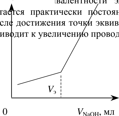
Рис. 7. Кривая кондуктометрического титрования слабой кислоты щелочью. V_3 – точка эквивалентности
