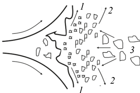
Рис. 4.5. Схема образования и распределения частиц красочной пыли в раскатной группе красочного аппарата:
