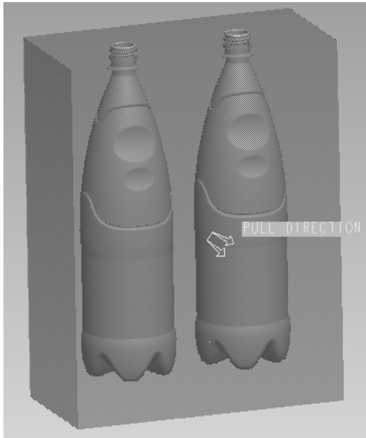
Рис. 3.3. Создание заготовки формообразующих деталей
