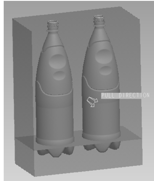
Рис. 3.4. Создание поверхности разъема формы и донной части
