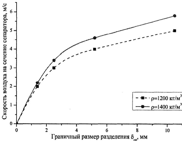
Рис. 4. Зависимость граничного размера разделения зерновых культур от скорости воздуха на сечение сепаратора
