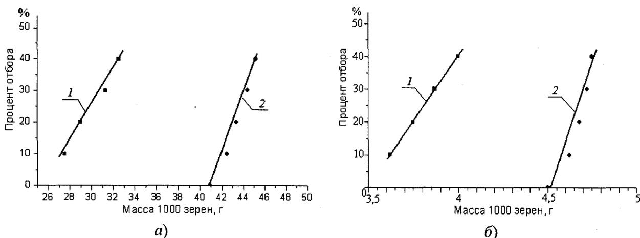
**Рис. 5. Изменение массы зерен ячменя (а) и рапса (б) в зависимости от доли отбора с воздушным потоком в многокаскадном сепараторе:**
