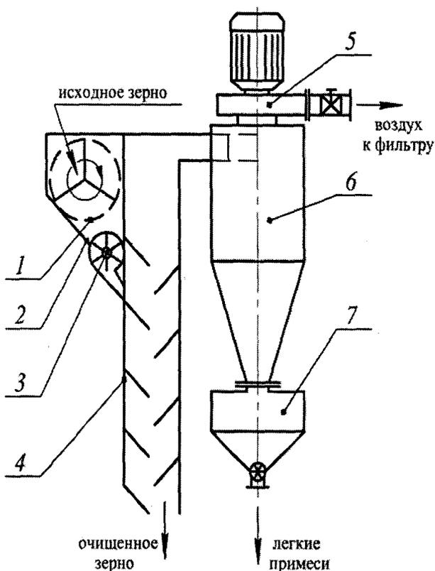
Рис. 2. Зерноочистительная машина с многокаскадным полочным сепаратором: 1 – перфорированный барабан; 2 – камера; 3 – питатель; 4 – полочный сепаратор; 5 – вентилятор; 6 – циклон; 7 – бункер
