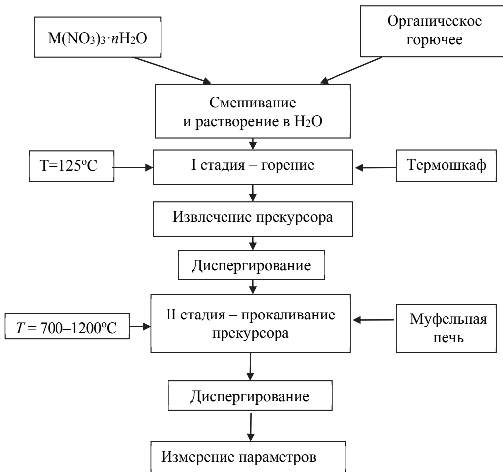
Рисунок 1 – Схема двухстадийного термохимического синтеза оксидных ультрадисперсных порошков (M – Y, Zn, Eu)
