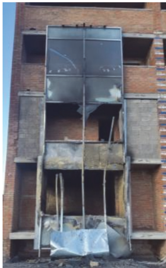
Рисунок 4 – Пример многоэтажного светопрозрачного фасада до (а) и после (б) испытаний
