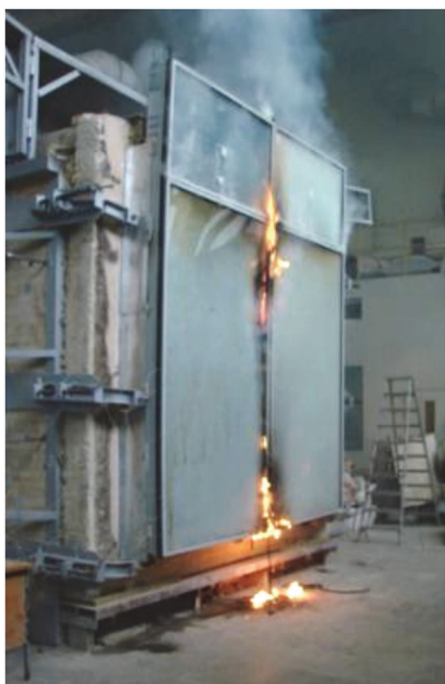
Рисунок 3 – Пример одноэтажного светопрозрачного фасада в начале ( a ) и в конце ( b ) испытаний
