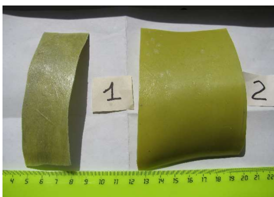
Рисунок 5 – Люминесцирующие полимерно-кристаллические композиты: 1 – без введения светорассеивающих частиц волластонита; 2 – с добавлением 5 мас.% волластонита
