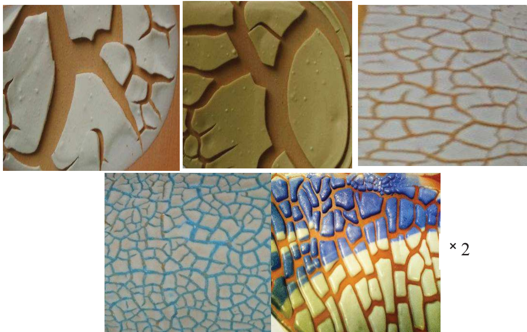
Рисунок 1 – Глазурные покрытия кракле
