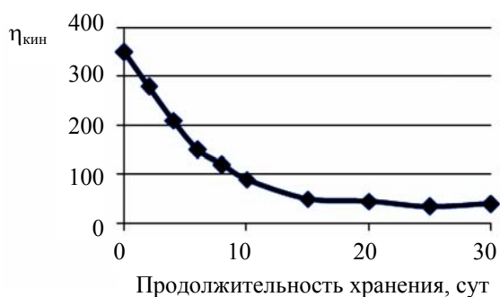
Рис. 1. Изменение кинематической вязкости полиимидных композиций в зависимости от продолжительности хранения при 20°C
