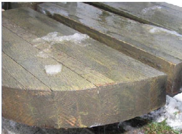
Рис. 2. Виды разрушений элементов деревянных скамеек
