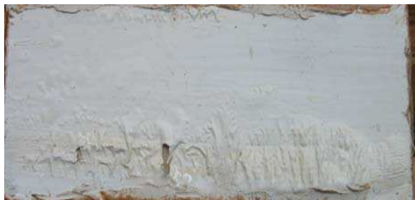
Рис. 3. Лакокрасочное покрытие образца четвертой партии (4-й цикл – камера искусственной погоды)
