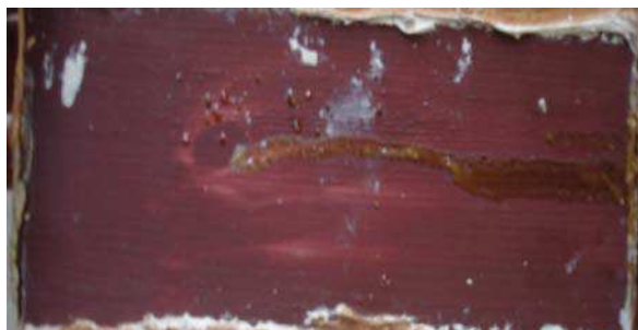
Рис. 12. Лакокрасочное покрытие образца третьей партии (9-й цикл – камера искусственной погоды)
