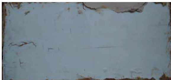
Рис. 10. Лакокрасочное покрытие образца второй партии (12-й цикл – камера искусственной погоды)
