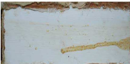
Рис. 7. Лакокрасочное покрытие образца второй партии (6-й цикл – камера искусственной погоды)
