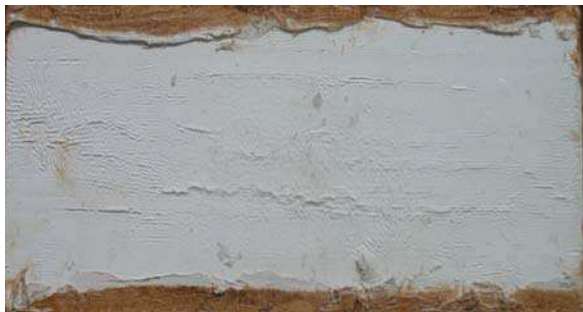
Рис. 1. Лакокрасочное покрытие образца четвертой партии (1-й цикл – камера холода)
