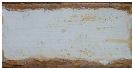
Рис. 4. Лакокрасочное покрытие образца первой партии (3-й цикл – камера искусственной погоды)
