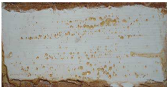
Рис. 5. Лакокрасочное покрытие образца первой партии (8-й цикл – камера искусственной погоды)
