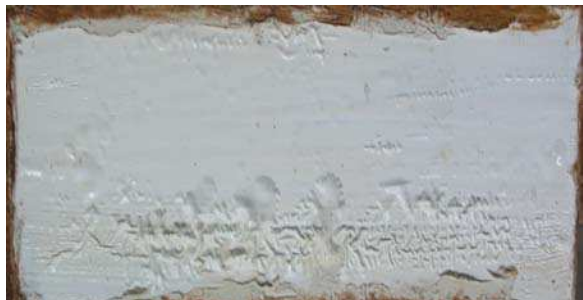
Рис. 2. Лакокрасочное покрытие образца четвертой партии (2-й цикл – камера искусственной погоды)
