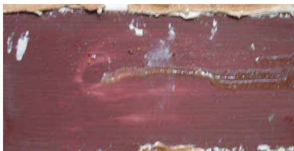
Рис. 11. Лакокрасочное покрытие образца третьей партии (6-й цикл – камера искусственной погоды)
