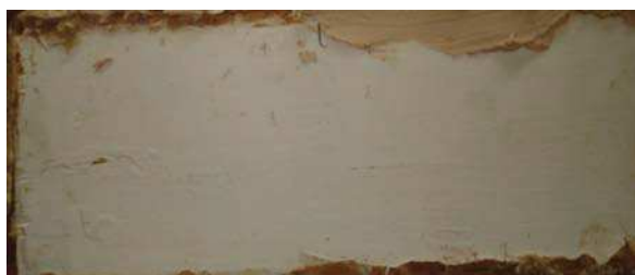
Рис. 9. Лакокрасочное покрытие образца второй партии (10-й цикл – камера искусственной погоды)
