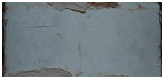
Рис. 6. Лакокрасочное покрытие образца первой партии (11-й цикл – камера искусственной погоды)
