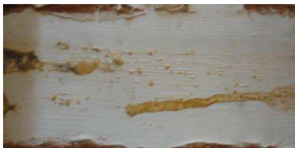
Рис. 8. Лакокрасочное покрытие образца второй партии (9-й цикл – камера искусственной погоды)
