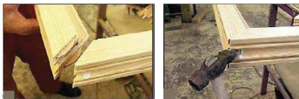
Рис. 3. Угловое соединение по технологии «Старт»
