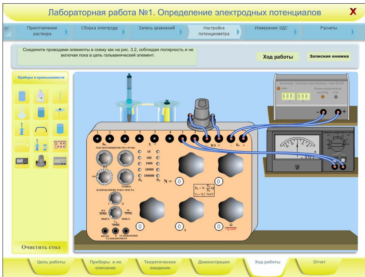
Рис. 3. Интерфейс окна проведения виртуальной лабораторной работы «Определение электродных потенциалов»
