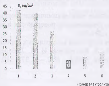
Рисунок 3 – Влияние добавок бентонитов на пористость покрытия толщиной 9 мкм
