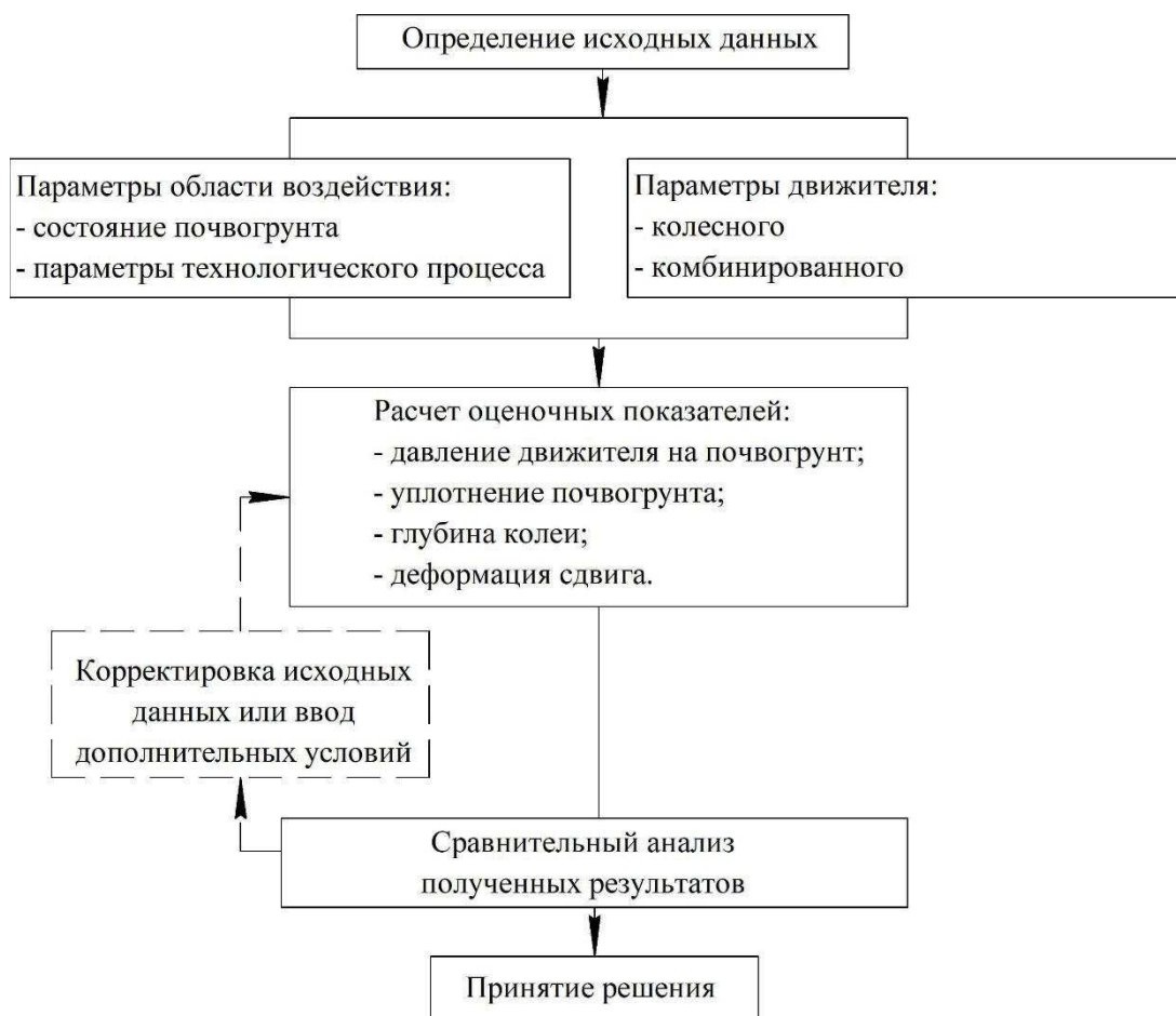
Рисунок 1 – Схема алгоритма сравнительного анализа движителей лесных машин
