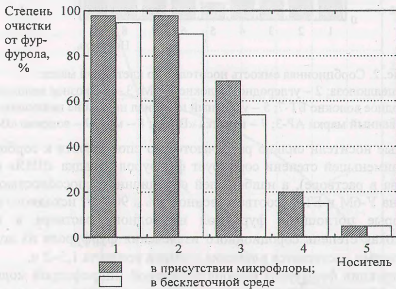
Рис. 4. Эффективность удаления фурфурола: 1 – углеродное волокно У-6М; 2 – углеродное волокно БТ-7; 3 – уголь активированный марки АР-3; 4 – волокно «Войлокарб»; 5 – насадка «ВИЯ»
