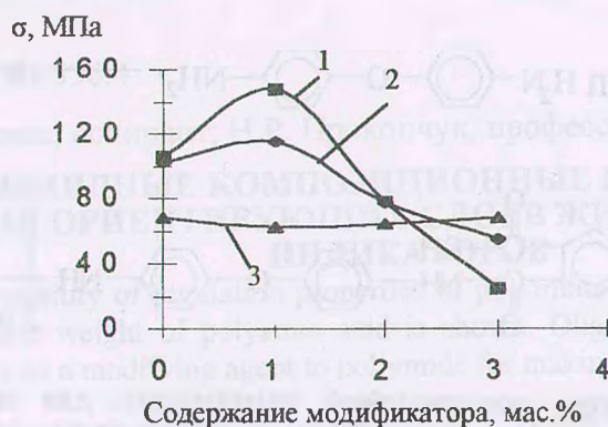
Рис. 1. Зависимость прочности при разрыве ( \sigma_p ) у образцов пленок, полученных из ПАК-композиций с различной удельной вязкостью ( \eta_{уд} ), от содержания модификатора (ОГМФ: 1 - \eta_{уд}=2.01 ; 2 - \eta_{уд}=1.42 ; 3 - \eta_{уд}=0.94 )
