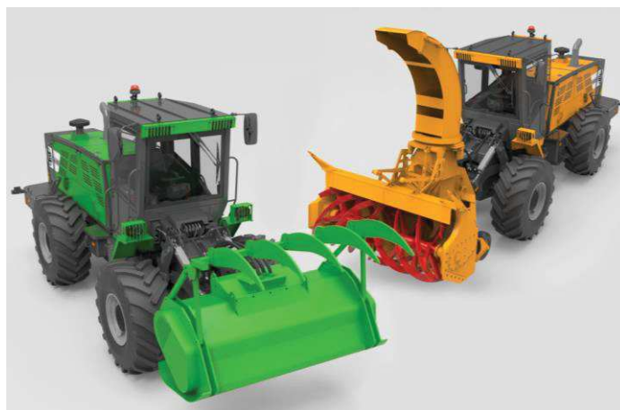
Рисунок 3 – Универсальное лесное шасси с различным технологическим оборудованием
