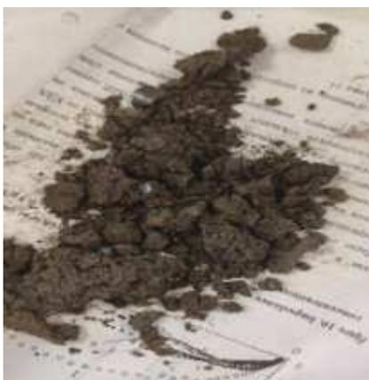
Рисунок 2. Мараганцево-цинковая смесь после фильтрования
