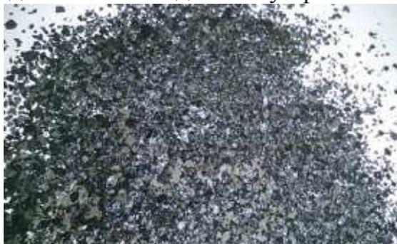
Рисунок 5. – Полученный диоксид марганца  $\gamma$ - модификации
