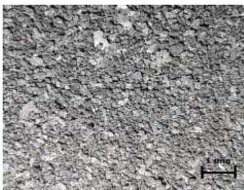
Рисунок 4. – Порошок цинка, полученный из щелочного электролита
