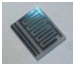
Рисунок 1. – Пленка состава 95%SnO 2 :5%ZnO с контактной металлизацией
