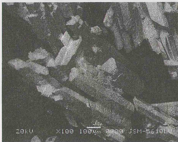
Рис. 1. Микрофотография кристаллов нитрата калия, полученных при конверсии раствора нитрата аммония хлоридом калия
