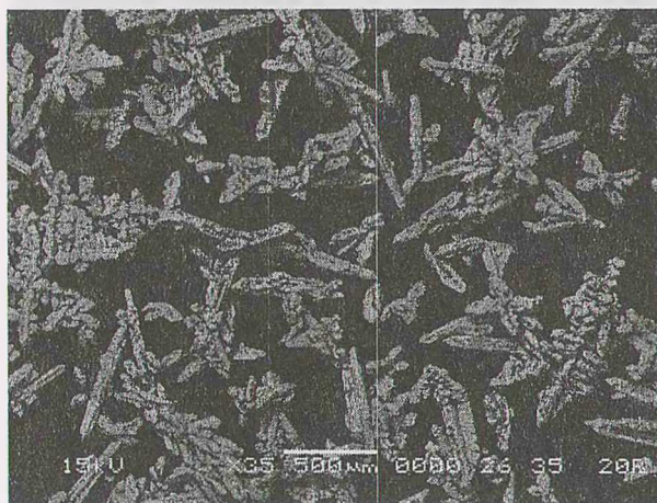
Рис. 8. Микрофотографии нитрата калия, полученного при скорости вращения мешалки 600 об/мин (скорость охлаждения – 4 град/мин)
