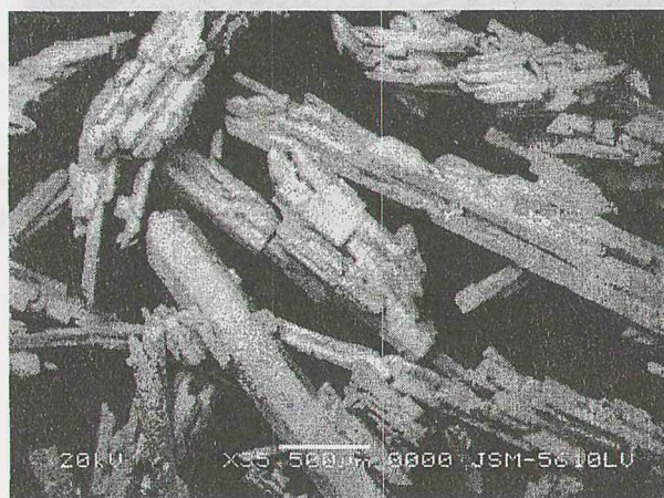
Рис. 2. Микрофотографии нитрата калия, полученного при скорости вращения мешалки 60 об/мин (скорость охлаждения – 1 град/мин)
