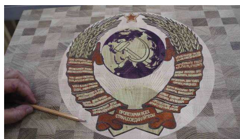
Рисунок 12 – Торцевые разделочные доски с обработкой на станках с ЧПУ
