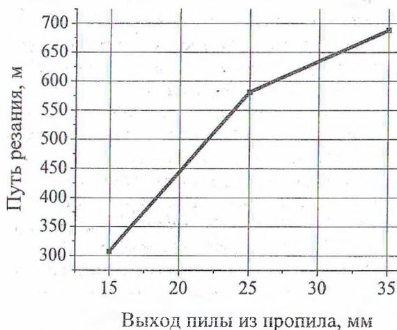
Рис. 4. Зависимость пути резания от выхода пилы из пропила при  $U_z = 0,04$  мм
