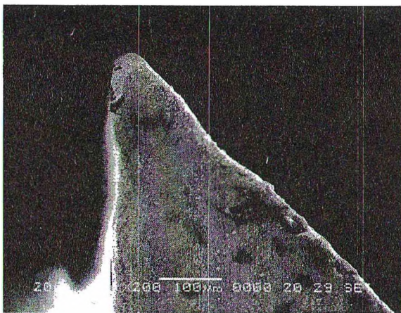
Рис. 8. Образование лунок на передней и задней грани реза
