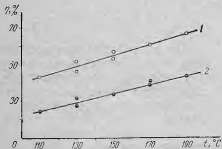
Рис. 5. Зависимость степени извлечения  $\eta$  от температуры воздуха:
