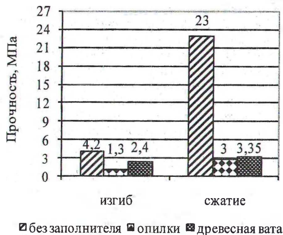
Рис. Влияние вида наполнителя на прочность при изгибе и сжатии
