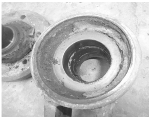
Рис. 6. Ступица АДУ-6 с ПСС после испытания
