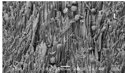
Рис. 5. Макрофотография торцевого среза технологической щепы ( \rho = 81 мкм)
