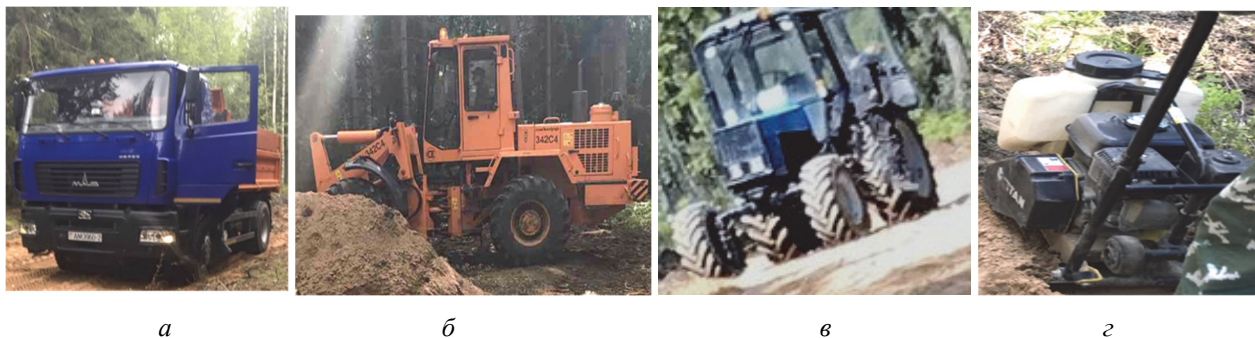
Рис. 11. Техника и дополнительное оборудование по устройству опытного участка: а – самосвал МАЗ 5550; б – фронтальный погрузчик «АМКОДОР 342С4»; в – плуг ПКЛ-70Д в агрегате с трактором МТЗ 892; г – виброплита Honda VM-60/5,5Н
