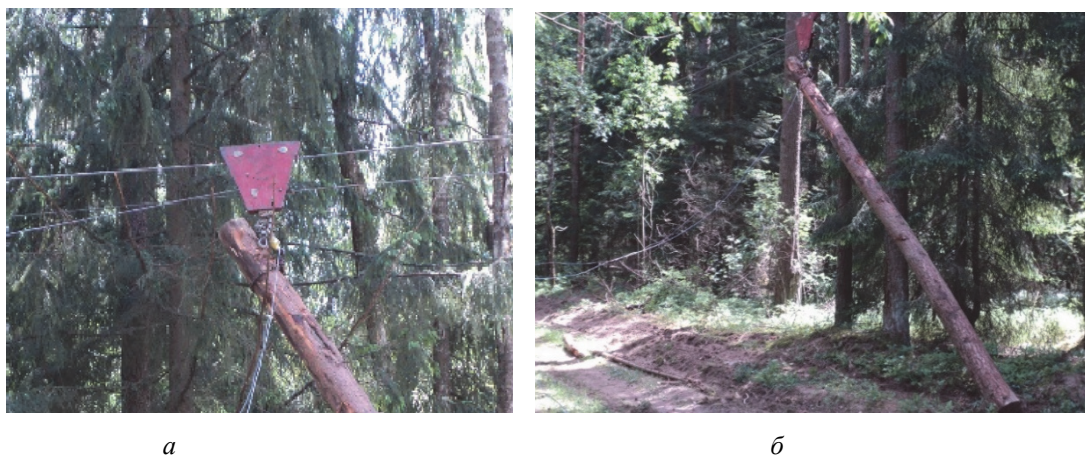
Рис. 3. Процесс перемещения бревна массой 260 кг по трелевочному коридору длиной 93 м: а – запасовка канатов в каретке; б – беспрепятственное движение вдоль трелевочного коридора
