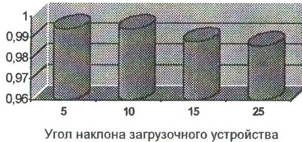
Рис. 2. Зависимость приведенного коэффициента эффективности от угла наклона загрузочного устройства
