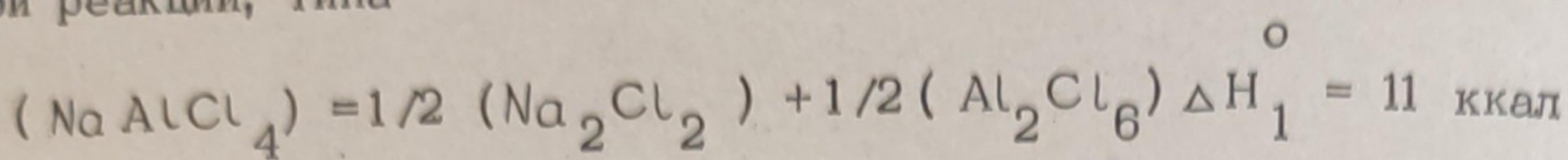
Если значение  $\Delta H_1^{\circ}$  процесса мало, то это должно свидетельствовать о близости свойств комплексного соединения с усредненными свойствами димерных молекул простых хлоридов. Для большинства изученных систем значение  $\Delta H_1^{\circ}$  указанного процесса невелико и колеблется около 10—15 ккал. Это и определяет тот факт, что свойства комплексных и димерных молекул хлоридов близки по своей природе.
