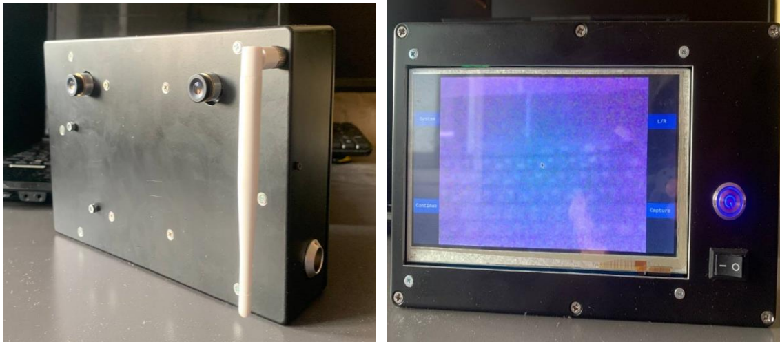
Рисунок 1 – Внешний вид опытного образца портативного электронного устройства для определения диаметров, количества и объема круглых лесоматериалов
