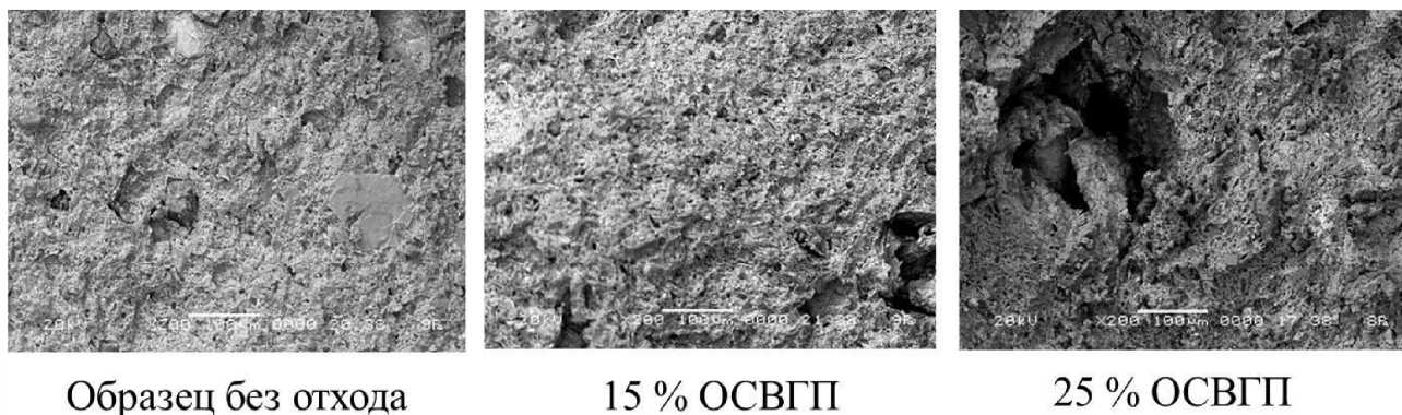
Рис. 1. Микроструктура образцов керамического кирпича
