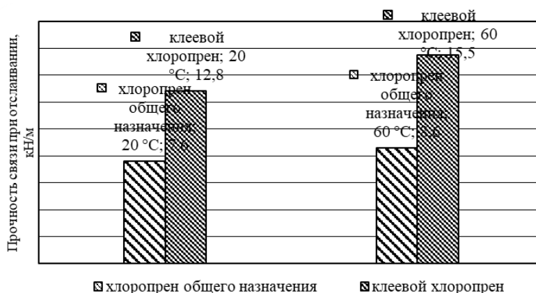
Рисунок 1 – Влияние марки полихлоропрена и температуры нанесения слоев клеевых композиций на прочность связи резины с металлом
