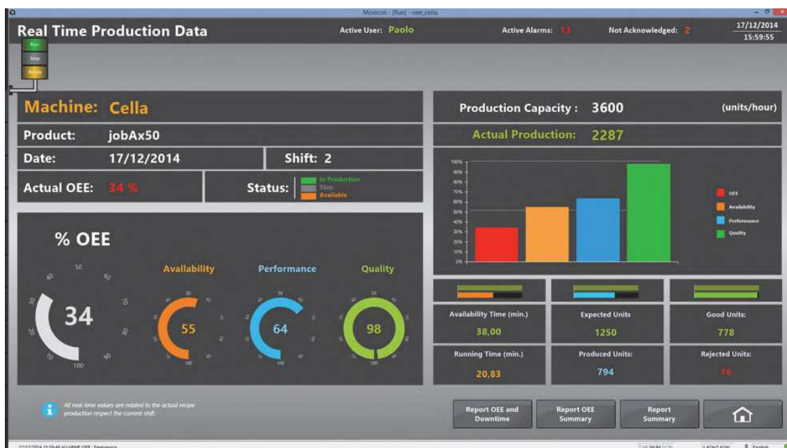
Рисунок 1 – Визуальное представление бизнес-индикаторов функционирования предприятия (в частности, OEE) на основе информационных панелей
