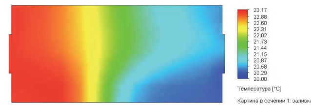
Рисунок 5 – Распространение температуры в помольном барабане
