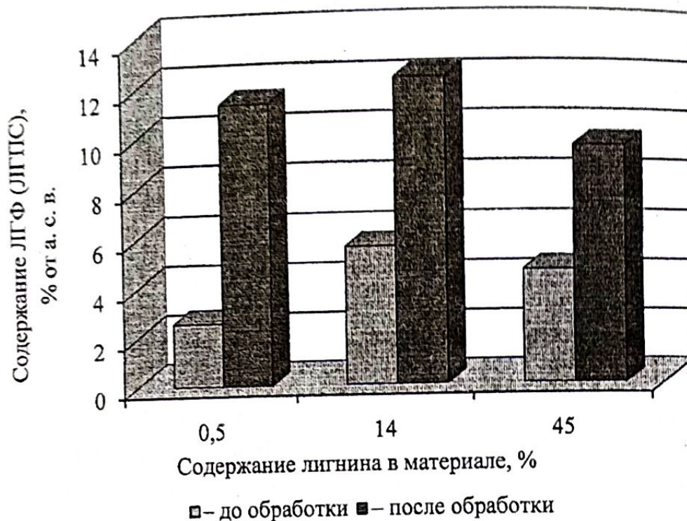
Рисунок 3 – Влияние лигнина на содержание легкогидролизуемых фракций (ЛГФ) при СВЧ-обработке целлюлозы и легкогидролизуемых полисахаридов (ЛГПС) – целлолигнина
