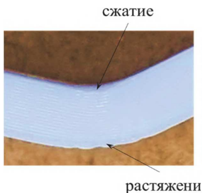
Рисунок 7 – Области сжатия и растяжения при разрушении образца
