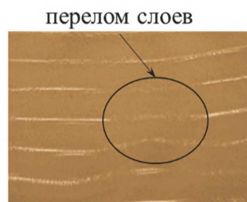
Рисунок 8 – Перелом сжатых слоев при разрушении образца
