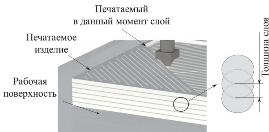
Рисунок 1 – Схема образования слоистости в напечатанном образце
