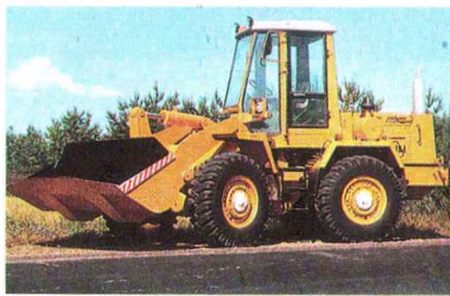
Пагрузчыкі акцыянернага гаварыства «Амкадор»: 1 — аднакаўшовыя франтальныя колавы; 2 — перарываўнага дзеяння з фрэзерным сілкавальнікам і паваротным транспарцёрам.
