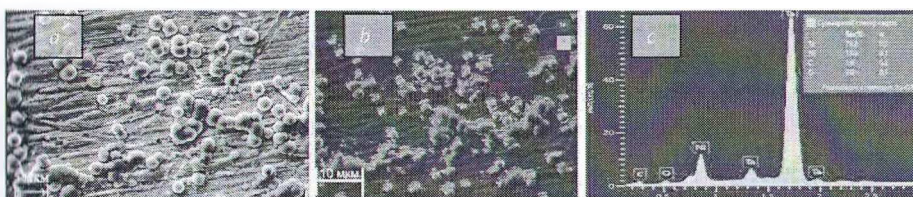
Рис. 2. СЭМ-изображения (a, b) и распределение химического состава (c) поверхности пленки \text{Ni} , электроосажденного при плотности тока 25 \text{ mA/cm}^2
