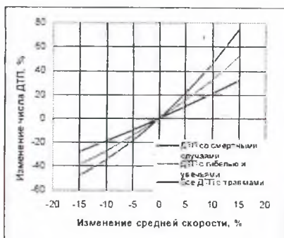
Рисунок 2 – Силовая модель Нильсона: соотношение между изменением средней скорости и ДТП
