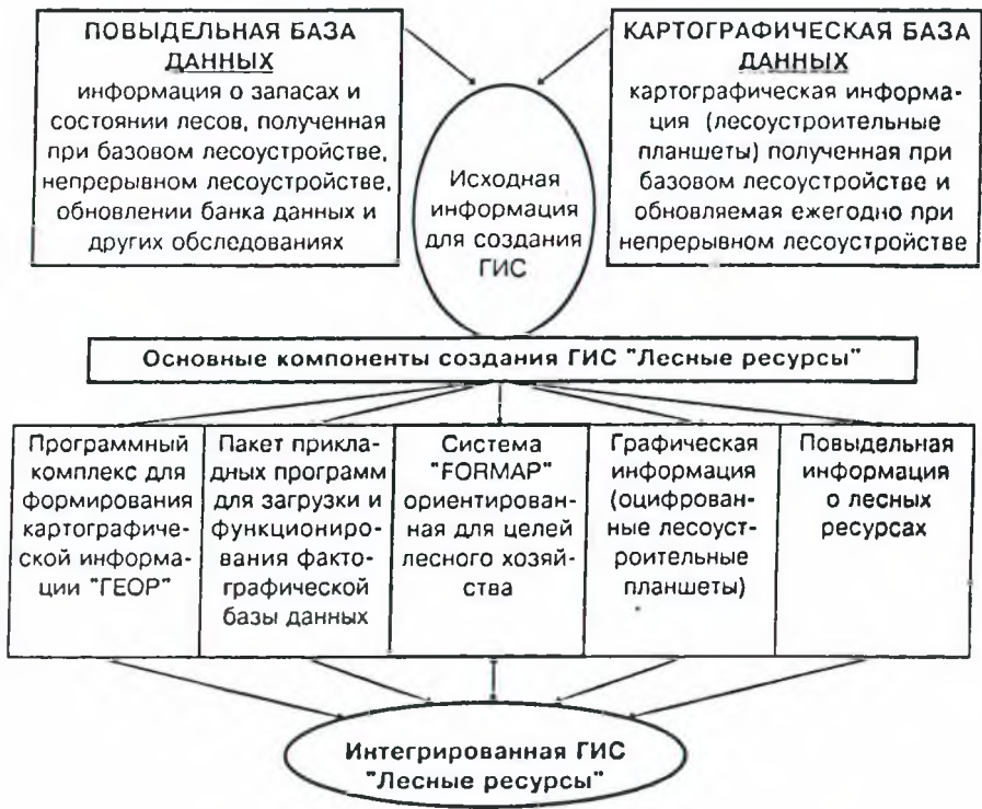
Рис. 4. Структурная модель интегрированной геоинформационной системы "Лесные ресурсы"
