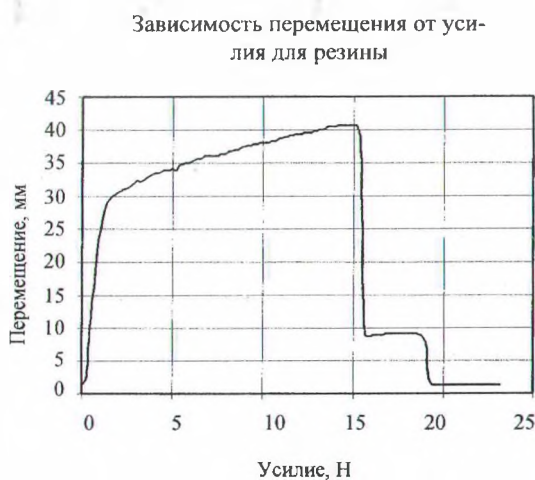
Рис. 7. График зависимости перемещения от усилия, приложенного к резине толщиной 2 мм
