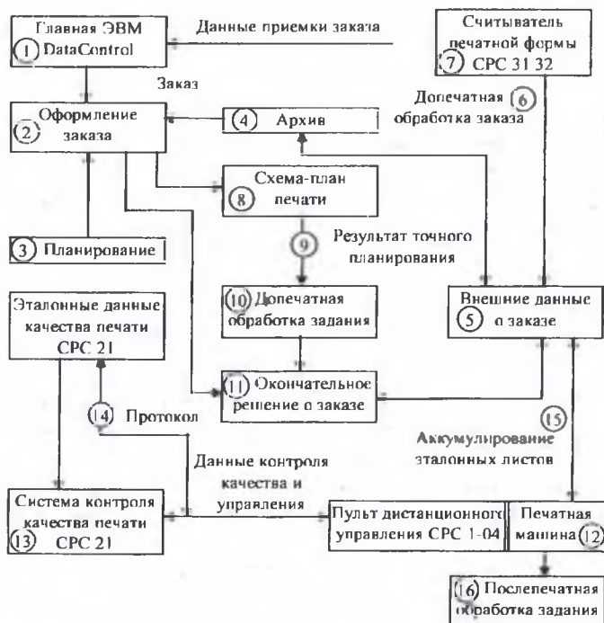
Рис. 5. Функциональная схема производственно-информационной системы управления
