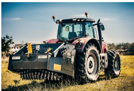
Рисунок 1 – Оборудование для фрезерования пней и грунта
