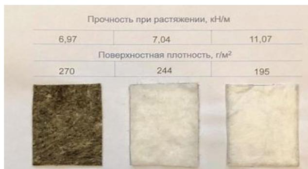
**Рисунок 2 – Прочность при растяжении нетканого геотекстиля произведенного по различной технологии и сырья**
