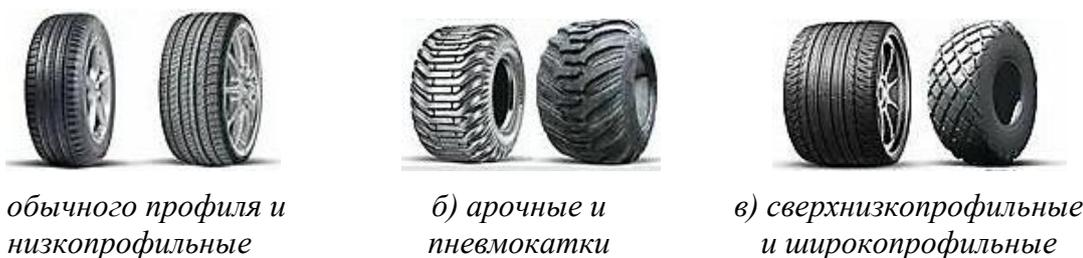
**Рисунок 5 – Классификация шин по форме профиля**
