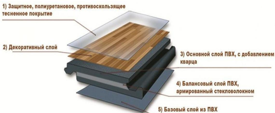
Рисунок 1 – Структура кварц-виниловой плитки
