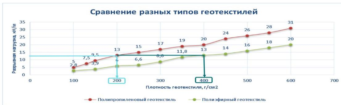
**Рисунок 1 – Зависимость прочности на разрыв от поверхностной плотности нетканого геотекстиля произведенного из различного сырья**
