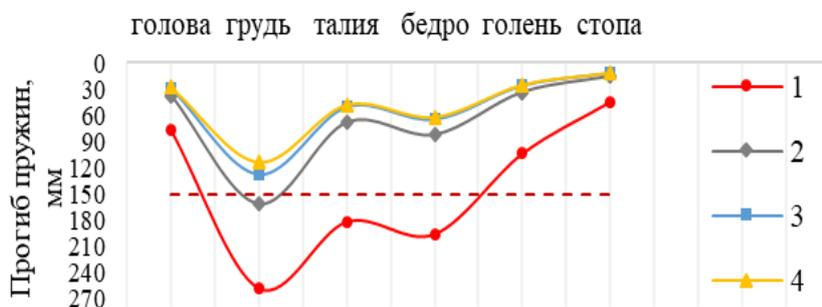
1 – оптимальные прогибы; 2 – прогибы при  $d=1,6$  мм; 3 – прогибы при  $d=1,7$  мм; 4 – прогибы при  $d=1,8$  мм; 5 – граница высоты пружинного блока
