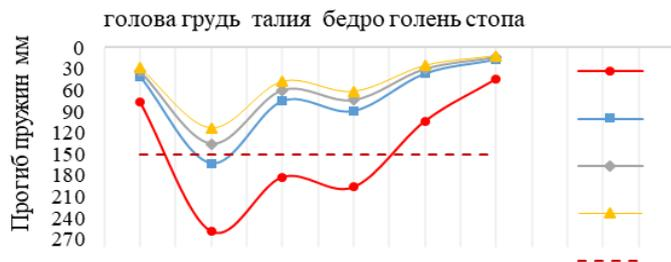
1 – оптимальные прогибы; 2 – прогибы при  $d=2,1$  мм; 3 – прогибы при  $d=2,2$  мм; 4 – прогибы при  $d=2,3$  мм; 5 – граница высоты пружинного блок
