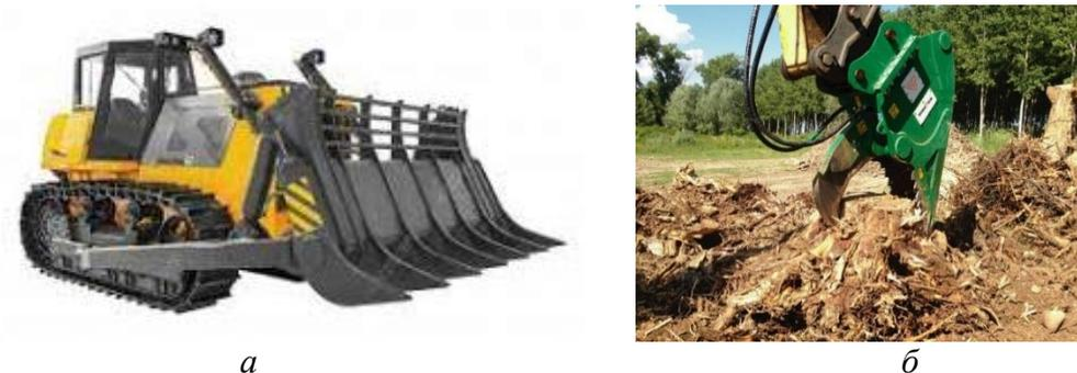
**Рисунок 3 – Корчеватель, работающий по методу прямого толкающего воздействия (а); корчеватель на базе одноковшового экскаватора (б)**
