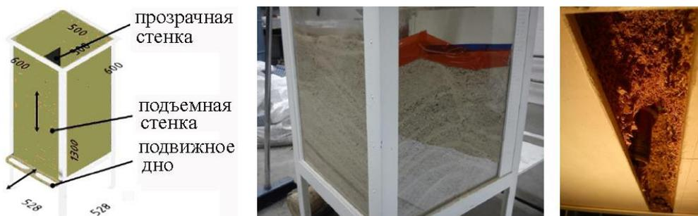
**Рисунок 1 – Схема модели бункера с картиной сегрегации и сводообразованием зависших опилок**
