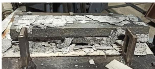
**Рисунок 3 – Отливка с элементами гарнисажа**
