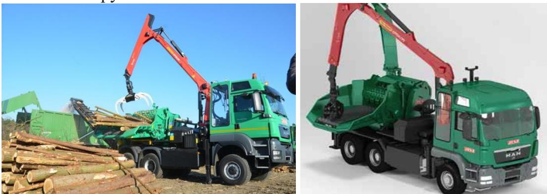
**Рисунок 3 – Мобильные рубительные машины JENZ GmbH с приводом от двигателя грузовика**
