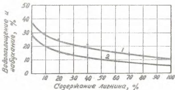
Рис. 6. Водопоглощение и набухание пластиков из смеси опилок березы и гидролизного лигнина: 1-водопоглощение за 24 часа; 2-набухание за 24 часа.
