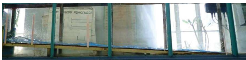
Рис. 4. Общий вид волны перемещения при мгновенном открытии затвора
