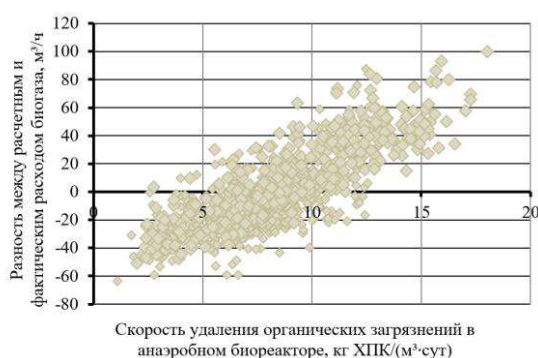
Рис. Зависимость разности предсказанного и фактического расходов биогаза от утилизированных в биореакторе органических загрязнений
