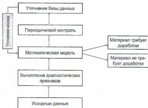
Рисунок 6 – Схема контроля качества подготовительной стадии издательско-полиграфического производства
