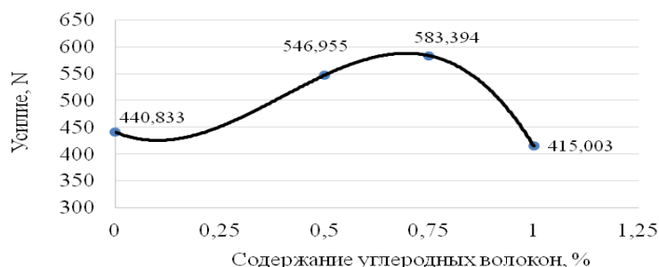
Рисунок 3 – Зависимость разрушающего усилия от содержания углеродных волокон
