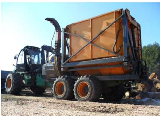
Рис. 3. Самоходная рубильная машина «Амкодор 2902»
