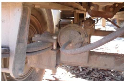
Рис. 4. Поддрессоренный остов рубильной машины «Jenz НЕМ 420»
