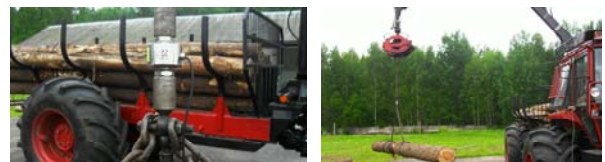
Рис. 6. Определение массы сортиментов
