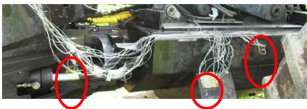
Рис. 8. Размещение тензометрических розеток на раме харвестера МЛХ-414
