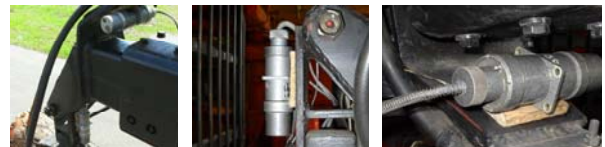
Рис. 5. Размещения датчиков ускорения МР-95 на манипуляторе форвардера
