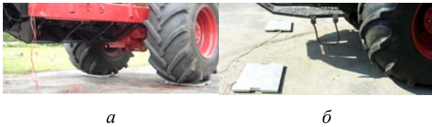
Рис. 3. Измерение опорных реакций переднего и заднего мостов форвардера
