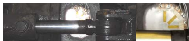
Рис. 2. Размещение прямоугольной тензометрической розетки на боковой грани шарнирного сочленения полурам
