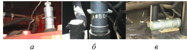
Рис. 1. Размещение датчиков ускорений на форвардере МЛПТ-354:
